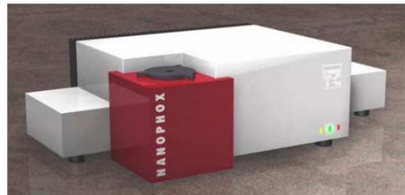
Зураг 5. 3D хөндлөнкорреляц дээр үндэслэсэн PCCS багаж: NANOPHOX (Symptec GmbH)
