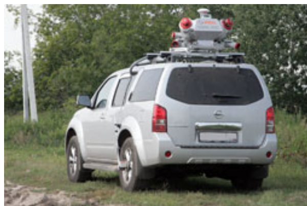
Зураг 9. Газрын лазер тандалтыг авто машин дээр суурилуулсан лидараар гүйцэтгэж байгаа нь
