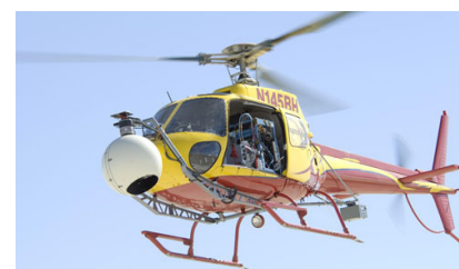
Зураг 2. Агаараас тандалт хийх лазерийн төхөөрөмжийг нисдэг тэргэнд суурилуулсан байдал
