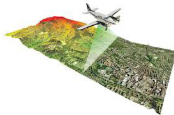
Зураг 3. Агаараас газрын хөрсний бохирдлыг лазерын төхөөрөмжөөр тандан судалж байгаа нь
