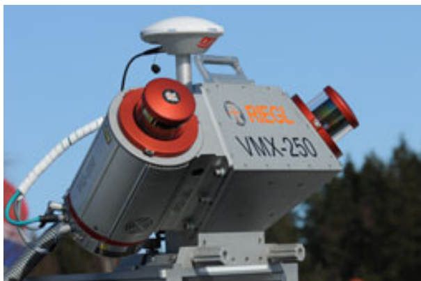
Зураг 9. Газрын лазер тандалтыг авто машин дээр суурилуулсан лидараар гүйцэтгэж байгаа нь
