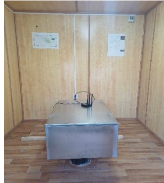
Цооногийн газар хөдлөлт хэмжигч: 100м цооногийн өрөмдөлт, багаж суурилуулсан байдал (Borehole station: Drilling for 100m; equipment installation)
