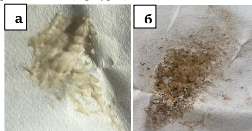
6-р зураг. Натрийн гидроксидын ( \text{NaOH} ) уусмалд хаг уусгасан байдал а-боловсруулалтын дараах хэлбэр б-хатсаны дараах хэлбэр
