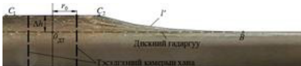
2-р зураг. Овойлтын гадаргуугийн ерөнхий хэлбэр. C_1 - муруй хэсэг; O_{DT} - овойлт хэлбэрийн деформацийн эхлэл буюу детонацын долгионы фронтын хавтгайн төв цэг; C_1 , C_2 - муруй хажуу ба тэгш хэсгийн уулзварын цэгүүд ба C_1 , C_2 хэрчим бол тэгш хэсэг; B - овойлтын хажуугийн муруй дискний гадаргуу дээр нийлж, тэгширэх хэсэг (детонацын гадаргуугийн захын цэг)
