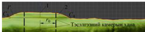
3-р зураг. Хэвнээ авсан дардасны гадаргуугийн ерөнхий хэлбэр. 1 - деформацийн гадаргуугийн бөмбөрцгийн сегмент хэлбэртэй хэсэг; 2 - сегмент ба конусын хилийн шугам; C_3 , C_4 - муруй хажуу ба тэгш хэсгийн уулзварын цэгүүд
