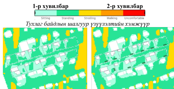
12-р зураг. 3-р байршлын загваруудын тухлаг байдлын шалгуур үзүүлэлтийн туршилтын үр дүн
