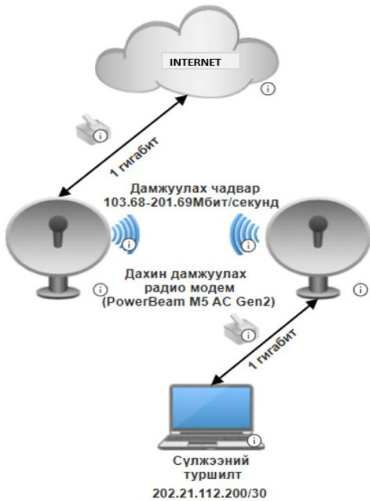
3-р зураг. Дахин дамжуулах радио модем ашиглаж буй холболтын топологи
