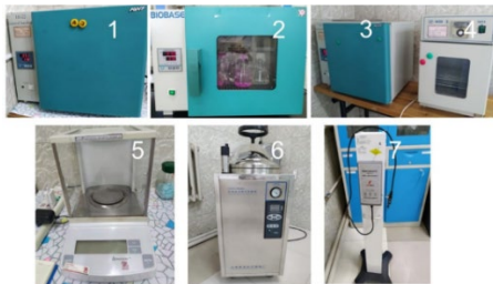
4-р зураг. 1, 2, 3 - 37°C-ийн халуун тогтоогуур, 4- 42-43°C-ийн халуун тогтоогуур, 3-44°C-ийн халуун тогтоогуур, 5- Аналитик эжин, 6- Автоклав, 7- Зөөврийн UV гэрэл
