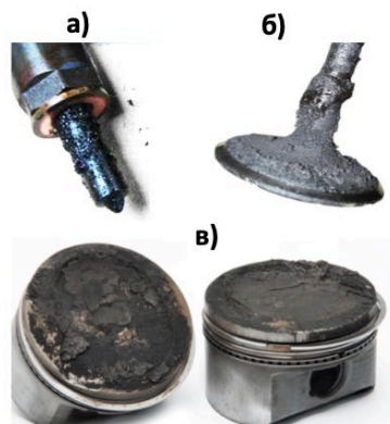
4-р зураг. Хөдөлгүүрийн эд ангид үүсэх хаг, хөө, тортог а) инжектор, б) хавхлага, в) поршен
