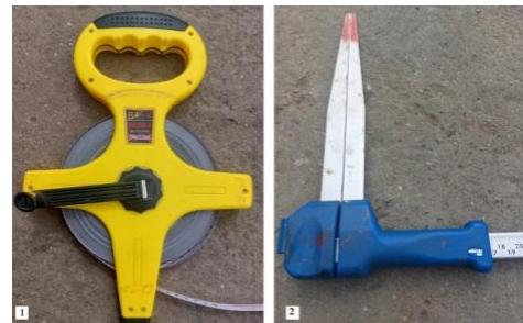
3-р зураг. Нарсан тууш хэмжилтийн хэрэглэгдэхүүн (1-туузан метр. LZYZ1000005, 2-хэмжигч ац метр. S-88200)
