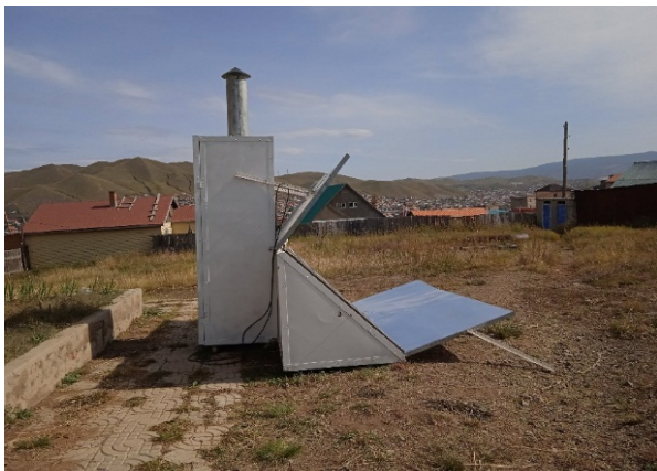
2-р зураг. Нарны энергийг хуримтлуулан ашиглах материалын хатаалгын төхөөрөмжийн туршилтын стенд
