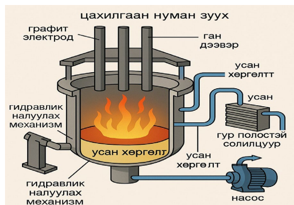
1-Р Зураг Ган хайлах зуухны ерөнхий бүтцийн схем (Цахилгаан нуман зуухны (EAF) хөргөлтийн системийн зураг
