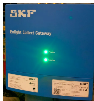
3-р зураг. Мэдрэгчээс мэдээлэл хүлээн авч, төв серверт илгээх трансмиттер.
