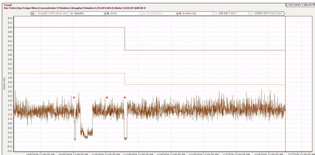
6-р зураг. Флотацийн цахилгаан хөтлүүрийн доргионы real-time хяналтын утга.
